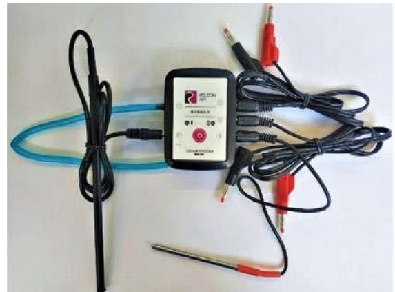
Рис. 9. Беспроводной мультидатчик Releon Air «Физика-5»
