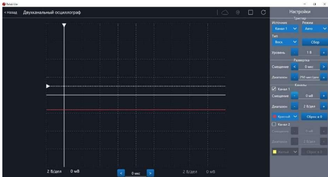
Рис. 40. Сигнал с ненулевым смещением
