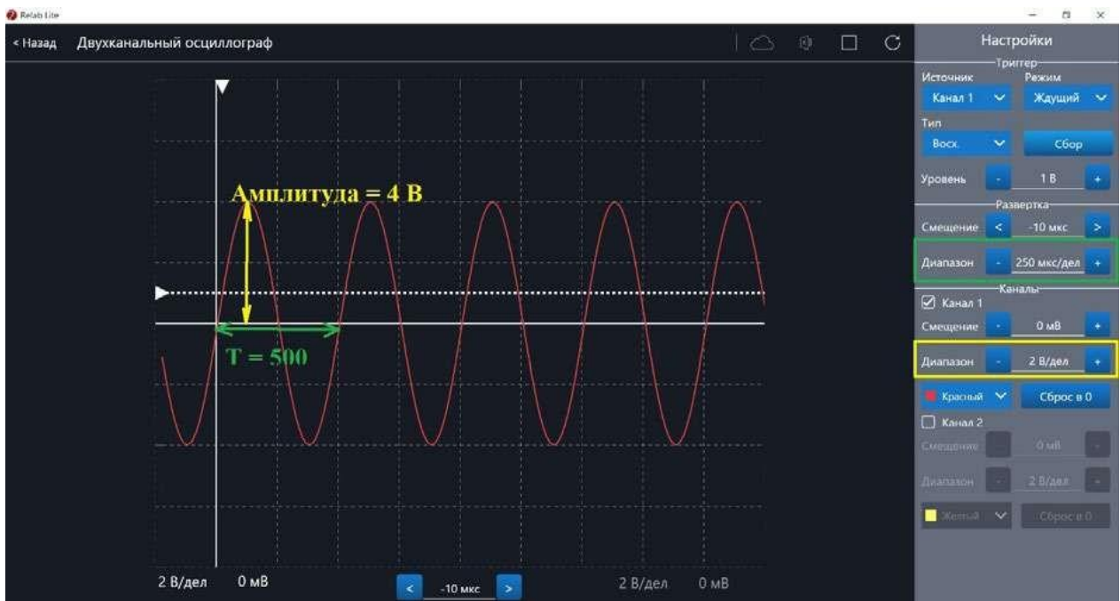
Рис. 42. Определение параметров осциллограммы
