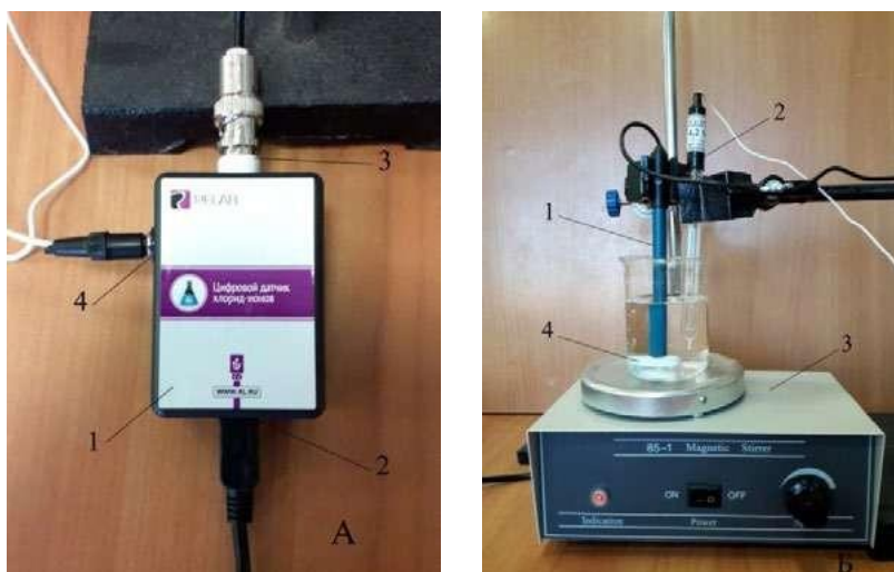
Рис. 2. Установка для определения концентрации (активности) хлорид-ионов в растворе. А: 1 — корпус датчика для определения \text{Cl}^- -ионов; 2 — разъем Micro USB для подключения к компьютеру; 3 — разъем BNC для подключения рабочего электрода; 4 — разъем для подключения электрода сравнения. Б: 1 — ионоселективный электрод (рабочий электрод); 2 — электрод сравнения (хлорсеребряный электрод); 3 — магнитная мешалка; 4 — якорь магнитной мешалки
